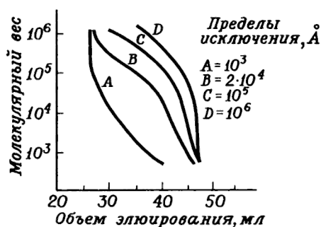
Р и с. 5.11. Соотношение между молекулярным весом и объемом элюирования для стирол-дивинилбензольных гелей (растворенные вещества: полистиролы; подвижная фаза: тетрагидрофуран) [22].
